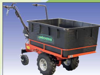
2 Schwenkräder verhindern das Kippen der Maschine
