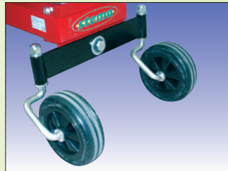
2 Schwenkräder verhindern das Kippen der Maschine
